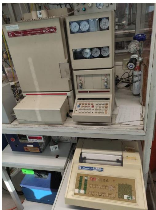
Figura 31 - Equipamento de cromatografia gasosa com plotter para imprimir os cromatograma
