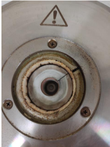
Figura 28 - Forno onde é colocado o cadinho de alumina com a amostra
