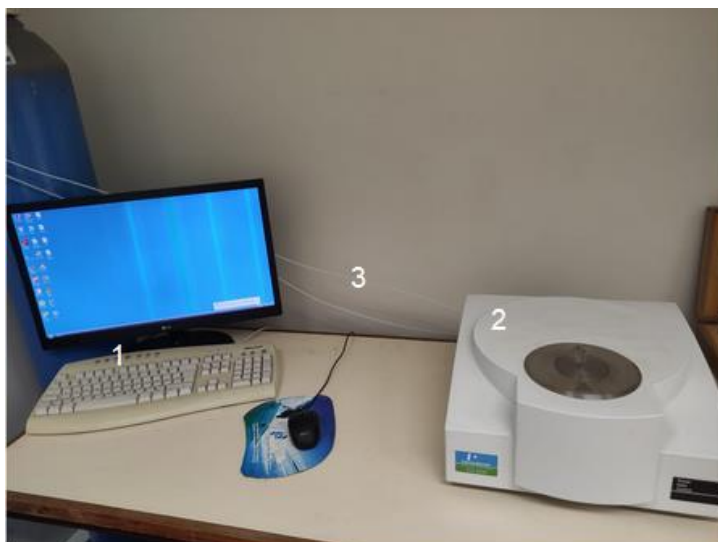
Figura 24 - Equipamento de TGA-DSC. 1 - Computador; 2 - Perkin-Elmer STA 6000; 3 - Linha de N 2
