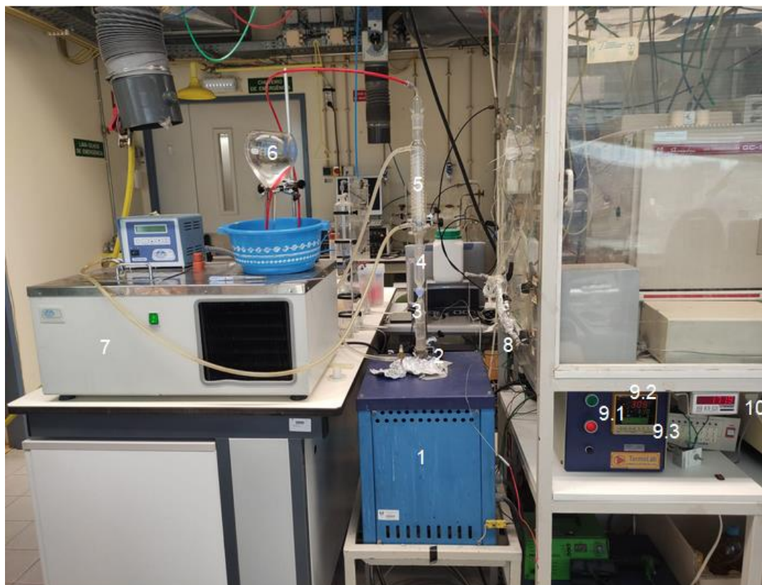
Figura 30 - Montagem dos ensaios de reator. 1 - Forno; 2 - Reator; 3 - Adaptador; 4 - Coletor; 5 - Condensador; 6 - Balão volumétrico; 7 - Termorregulador; 8 - Termopar; 9 - Display das temperaturas: 9.1 - Temperatura SetPoint; 9.2 - Temperatura do reator; 9.3 - Botões de programação; 10 - Temperatura do forno
