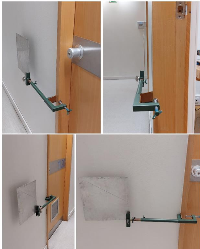
Figura 5.3.3. Montagem da placa metálica (alvo) atrás da parede
