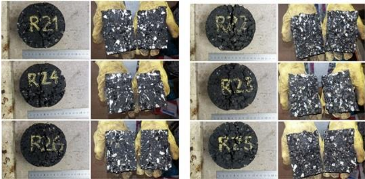
Figura 3.3 – Provetes da mistura MR após ensaio ITSR e tipo de rotura – grupo “dry” (à esquerda) “wet” (à direita)
