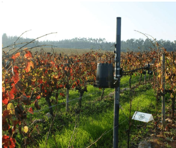
Figura 6: Sensor para monitorizar a temperatura, humidade do ar e da folha, entre outras (extraído de [25])
