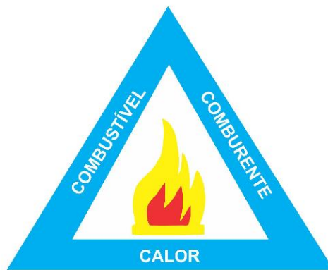
Figura 1 – Triângulo do fogo. Adaptado de Extingue incêndios .
