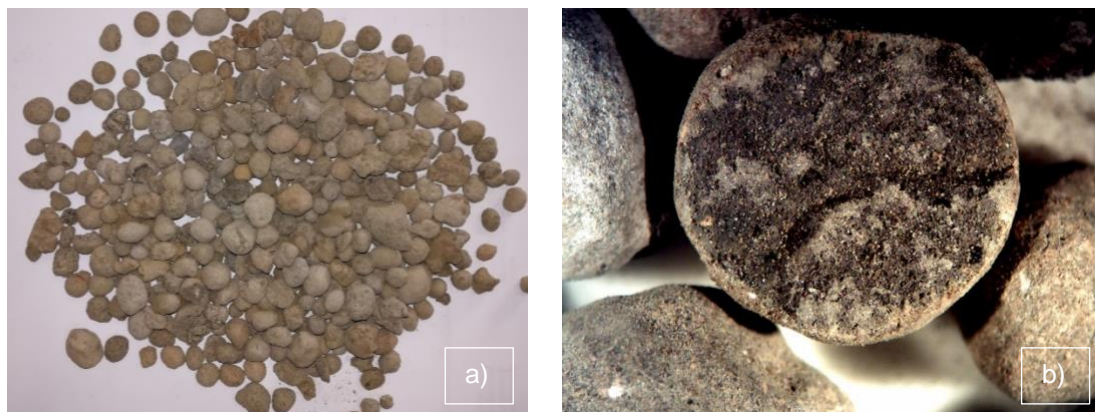
Figura 3.2 - Agregado leve de argila expandida a) aspeto das partículas; b) partícula de leca com estrutura interna porosa envolta por camada compacta de algumas dezenas de micrómetros
