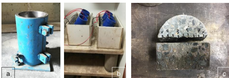
Figura 3.7 - a) molde metálico; b) ensaio acelerado de migração de cloretos; c) método colorimétrico;
