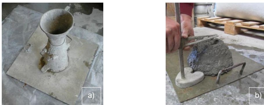
Figura 3.6 - a) Equipamento para o ensaio de abaixamento e b) ensaio de abaixamento
