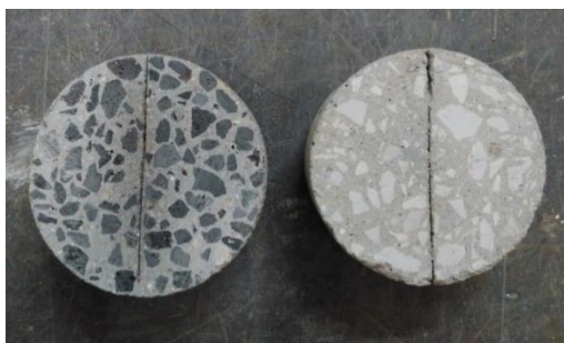
Figura 6: Provetes para ensaio de carbonatação e cloretos
