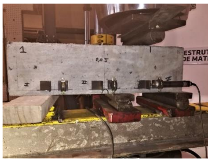
Figura 10: Exemplo de viga a ser ensaiada
