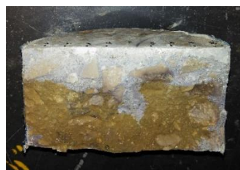
Figura 22: Provetes com fissuras naturais resultantes do ensaio
