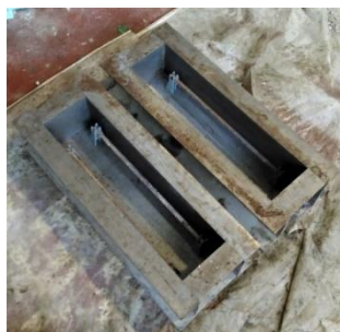
Figura 8: Moldes para a betonagem dos provetes sujeitos a fendilhação natural
