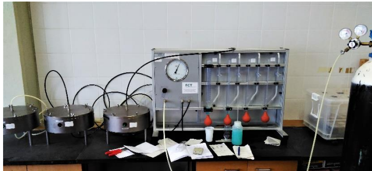
Figura 17: Equipamento utilizado para o ensaio de permeabilidade ao oxigénio
