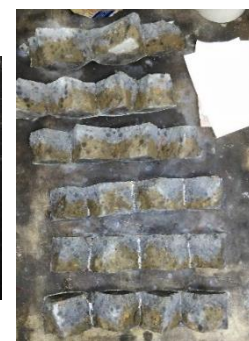
Figura 22: Provetes com fissuras naturais resultantes do ensaio
