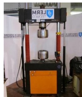
Figura 11: Prensa hidráulica INSTROM
