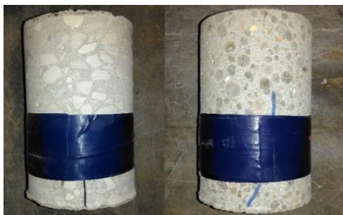
Figura 14: Provetes obtidos do processo de carotagem
