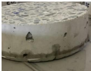
Figura 30: Ascensão de água por capilaridade num provete fendilhado de BEAL Stalite aos 10 minutos
