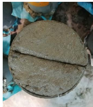
Figura 5: Provete após a remoção da chapa
