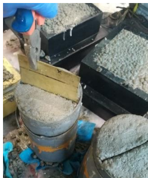
Figura 4: Remoção da chapa do interior do provete
