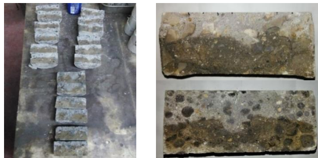
Figura 20: Provetes com fissuras artificiais resultantes do ensaio de resistência à penetração de cloretos
