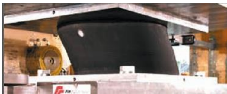
Figura 11 – Modo de deformação de Apoios de borracha de alto amortecimento. (FIP Industriale, 2016)
