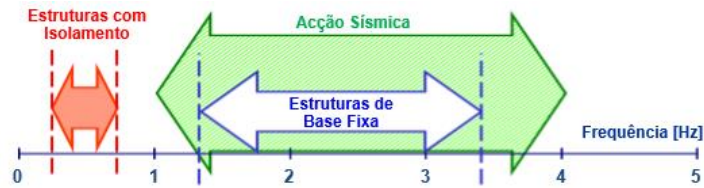
Figura 6 - Enquadramento das frequências de estruturas com isolamento e estruturas de base fixa no intervalo de frequências com maior conteúdo energético da ação sísmica (Guerreiro, 2004).
