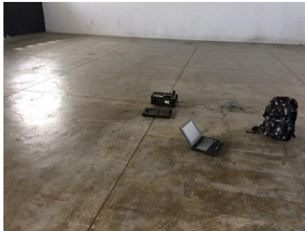
Figura 35 – Equipamento usado para medição das frequências do edifício
