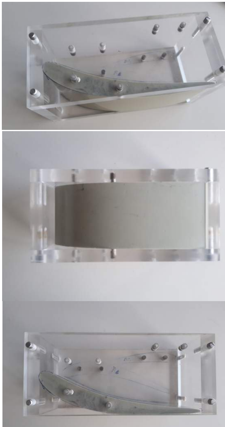
Figura C.2: Peça de verificação de geometria das pás diretrizes.
