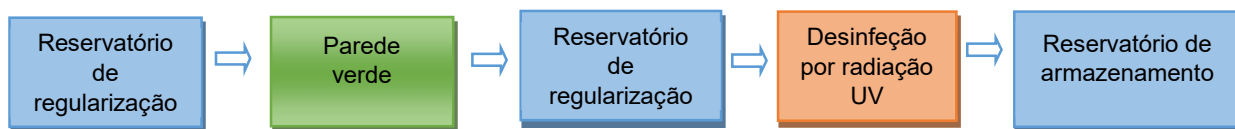
Figura 6.1 - Representação esquemática da solução de tratamento do pavilhão de civil do IST.
