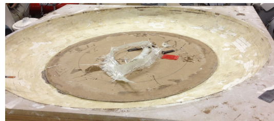
Figura A.8: Aspeto do molde depois da desmoldagem da primeira peça.
