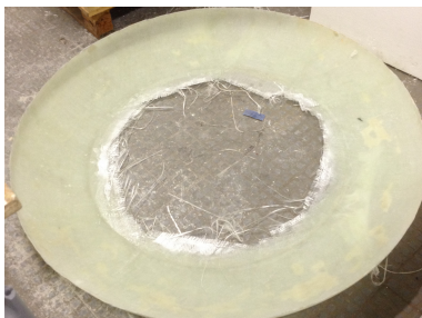
Figura A.7: Condução de entrada depois de desmoldada e sem a rebarba exterior.
