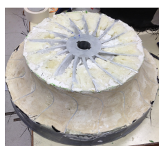
(b) Cobertura dos canais do rotor com a geometria pretendida.
