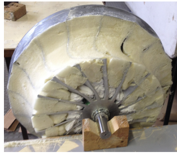
(b) Enchimento dos canais com poliuretano expansível.
