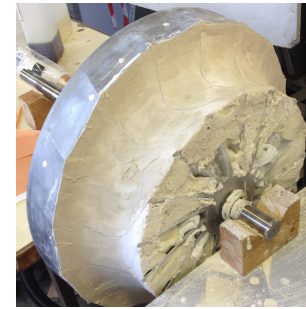
(c) Superfície do canal coberta com gesso.
