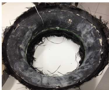
(a) Interior do invólucro após a desmoldagem.
