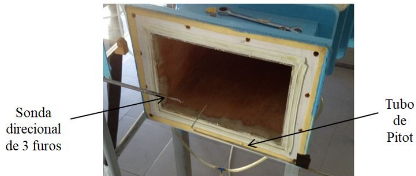
Figura 3.7: Alinhamento da sonda direcional de 3 furos e do tubo de Pitot à saída do túnel.
