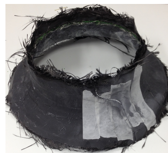
(b) Zona onde foi efetuado o corte para desmoldar.
