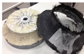
(c) Desmoldagem do invólucro do rotor.
