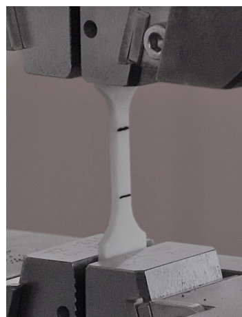
Figura 2.16: Ensaio de tração a um dos provetes de poliuretano compacto.
