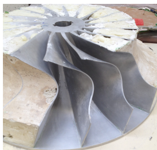
(a) Remoção do material nos canais do rotor.
