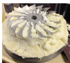
(a) Enchimento com poliuretano expansível.
