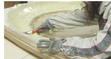
(c) Manufatura da peça pelo método wet lay-up .
