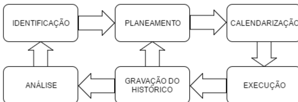
Figura 3.2 - Ciclo de Ações de Manutenção (adaptado de Dunn, 1999).
