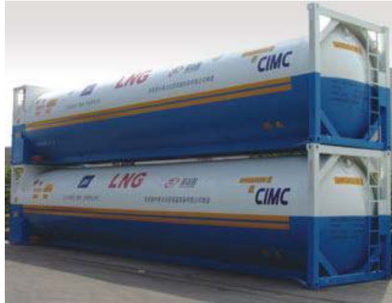
Figura 4.15: Tanque contentorizado de LNG (Wartsila LNG PAC)
