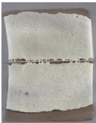
**Figura 34.** Exemplo do corte longitudinal numa espuma dispensada em molde.
