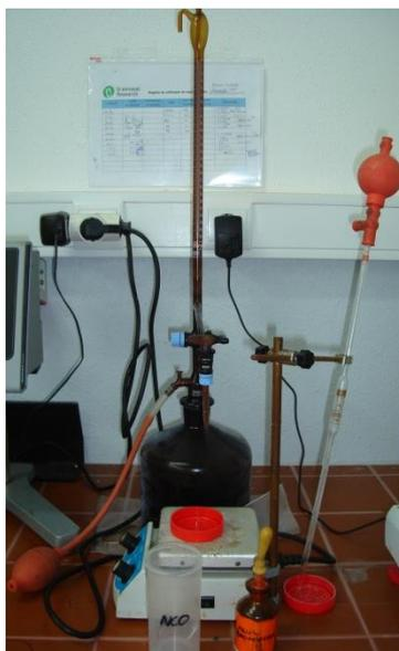
**Figura 30.** Montagem experimental para a medição do teor de NCO.
