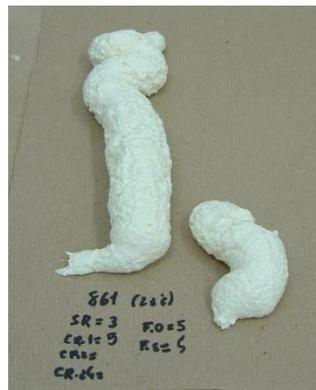
**Figura 31.** Exemplo de espuma dispensada em papel a 23°C.
