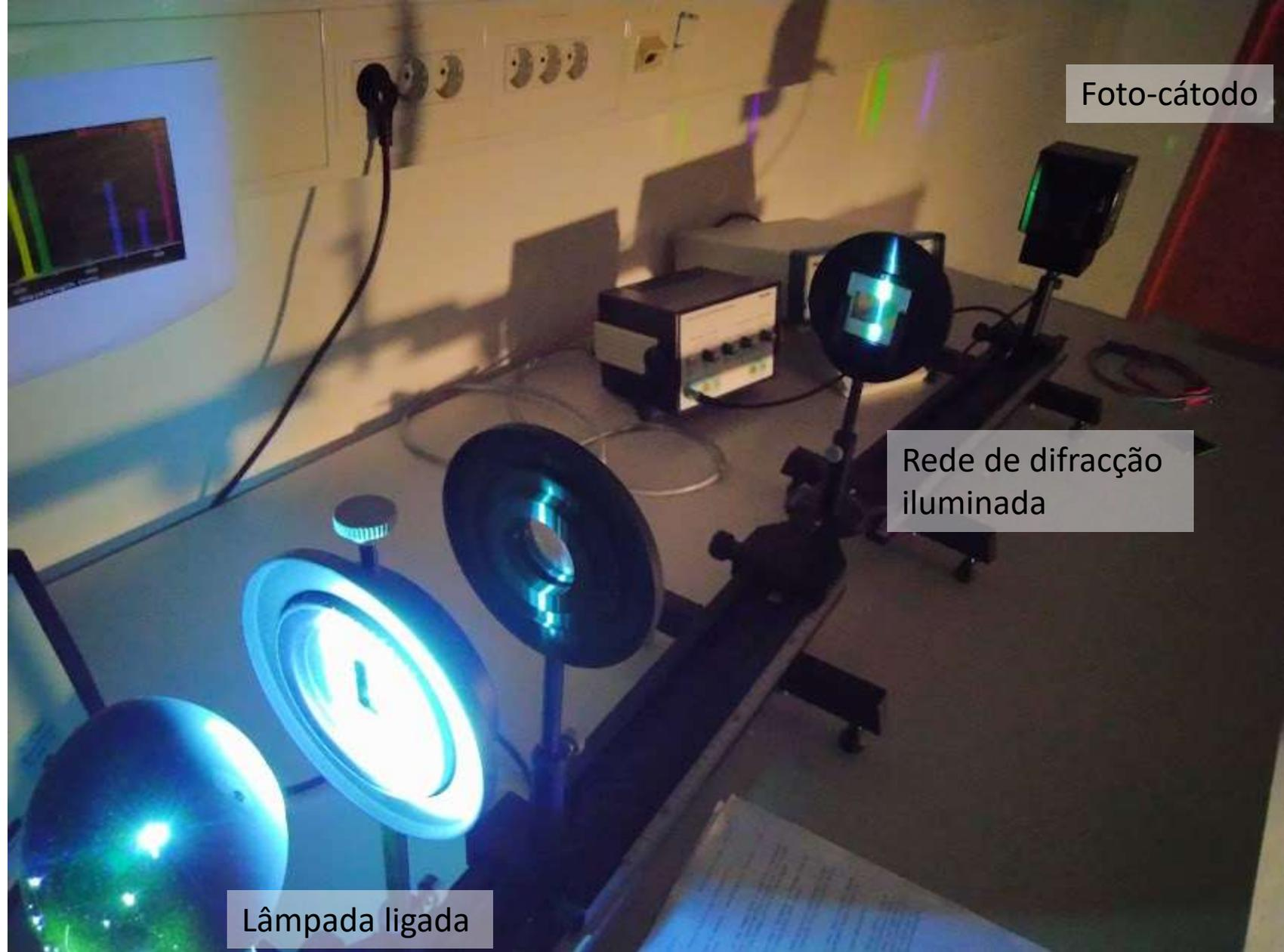
Bancada óptica com lâmpada, fenda, lente de focagem, rede de difracção e foto-cátodo.
