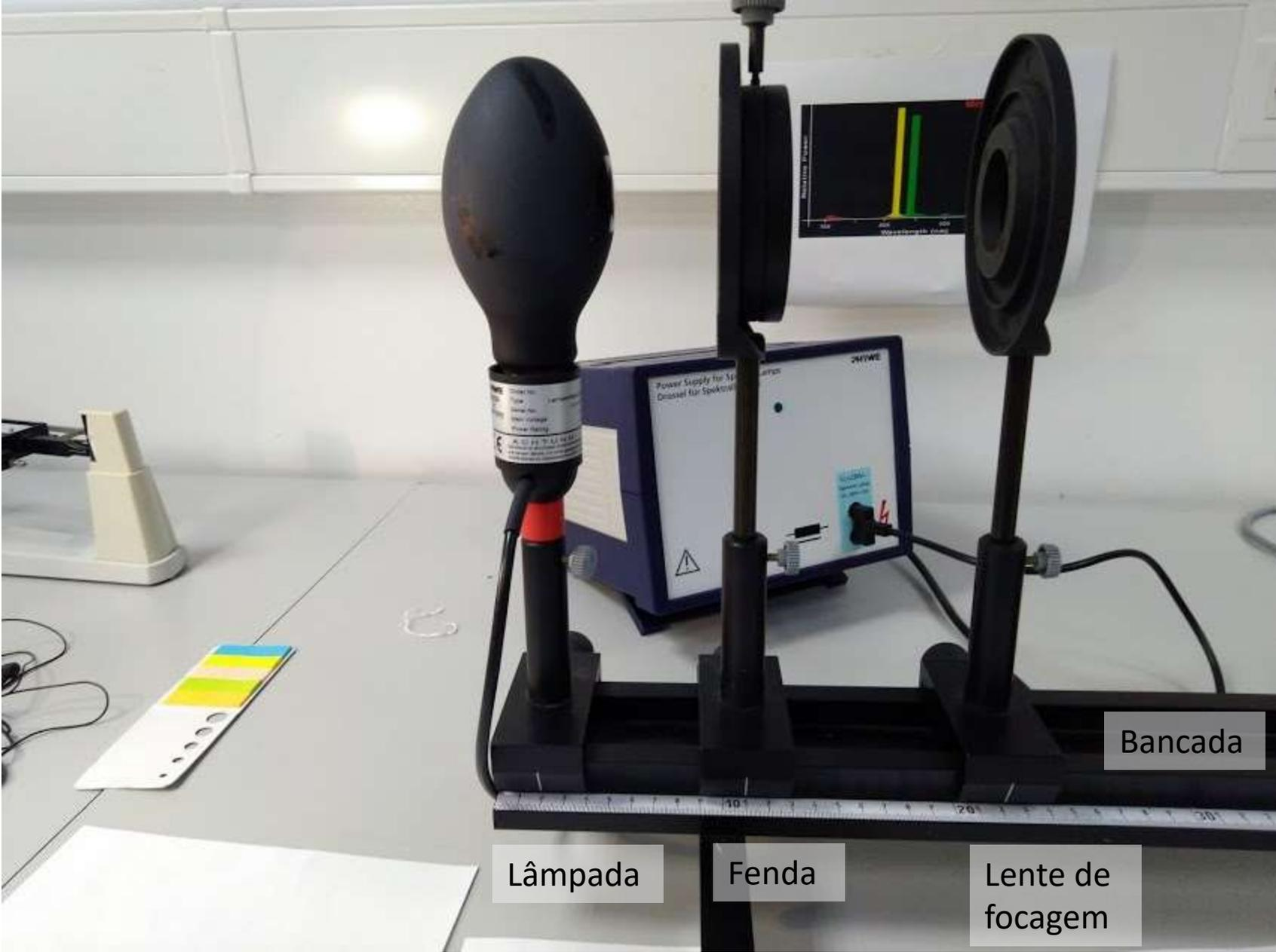
Bancada óptica com lâmpada, fenda e lente de focagem.
