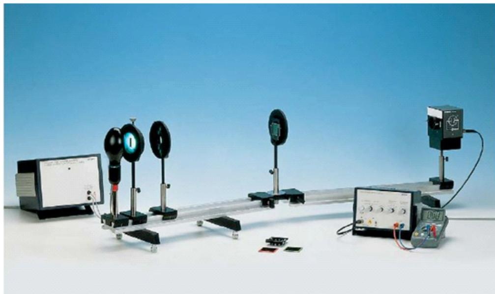
Fig. 5 – Instalação experimental para o efeito fotoelétrico
