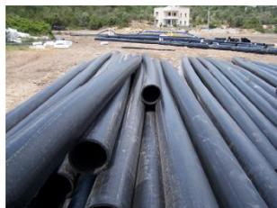
Fig. 83 – Tubos em HDPE utilizados em jaulas de aquacultura
