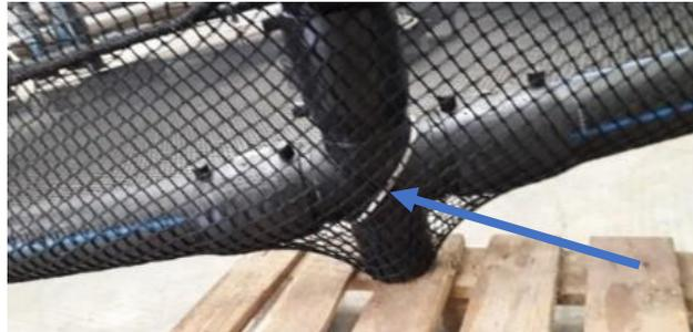
Fig. 104 – Laço de ligação do tirante à estrutura da gaiola
