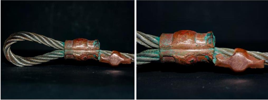
*Fig. 111 – Pormenor da soldadura do cabo – Cobre*
