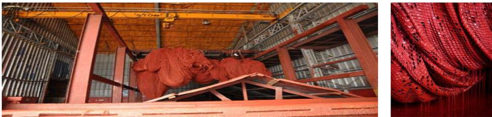
Fig. 90 – Rede imersa num tanque com antifouling
