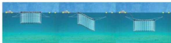
Fig. 37 – Simplificação da submersão duma gaiola OCEANIS
