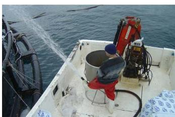
Fig. 48 - Canhão de alimentação conectado à bomba de água do barco.
