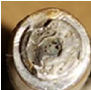
Fig. 16 – Fractured screw inside the central body Fonte: Francisco M. - IST
