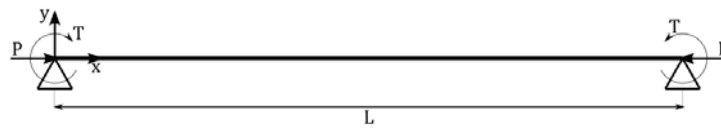
Figura 4.8: Modelo simplista dos esforços derivados de uma colisão numa esquina do veículo.
