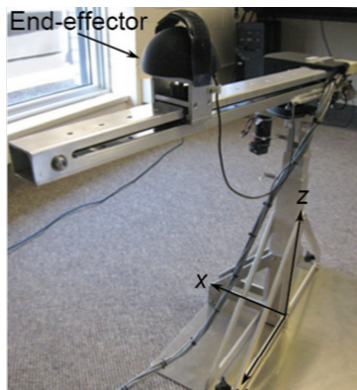
(a) Dispositivo robótico usado na reabilitação pós-AVC.
