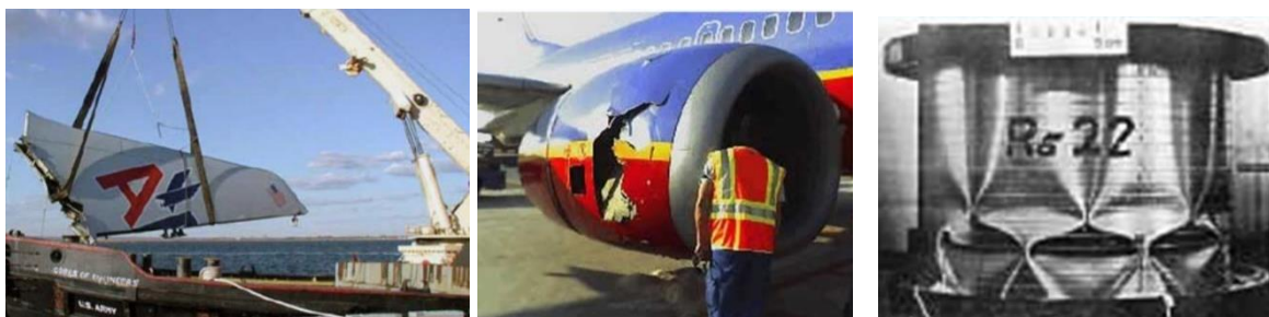
Figura 3 – Exemplos de modos de Fratura Estrutural: (esquerda) Estabilizador vertical - American Airlines Flight 587; (centro) Fluência – Southwest Airlines; (direita) Buckling: cilindro de teste sujeito a força compressiva
