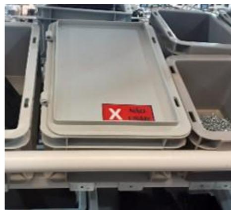
Figura 25 - Etiqueta "Não usar" colocada nas caixas de componentes
