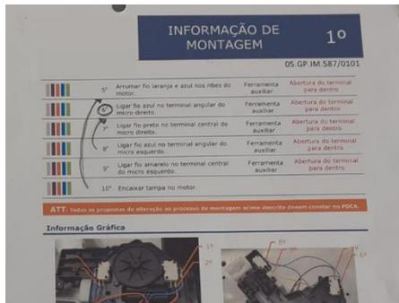
Figura 23 – Alterações ao Standard Work de um Posto
