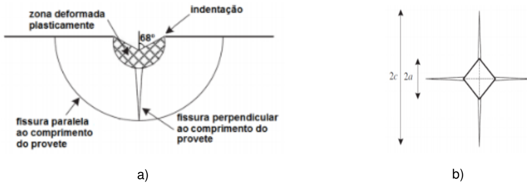
Figura 2.16: Representação esquemática [45] : indentação Vickers utilizada para a determinação de K_{1C} (figura a)) e indentação e fendas adjacentes usadas para a medição do K_{1C} , com as respectivas dimensões (figura b))
