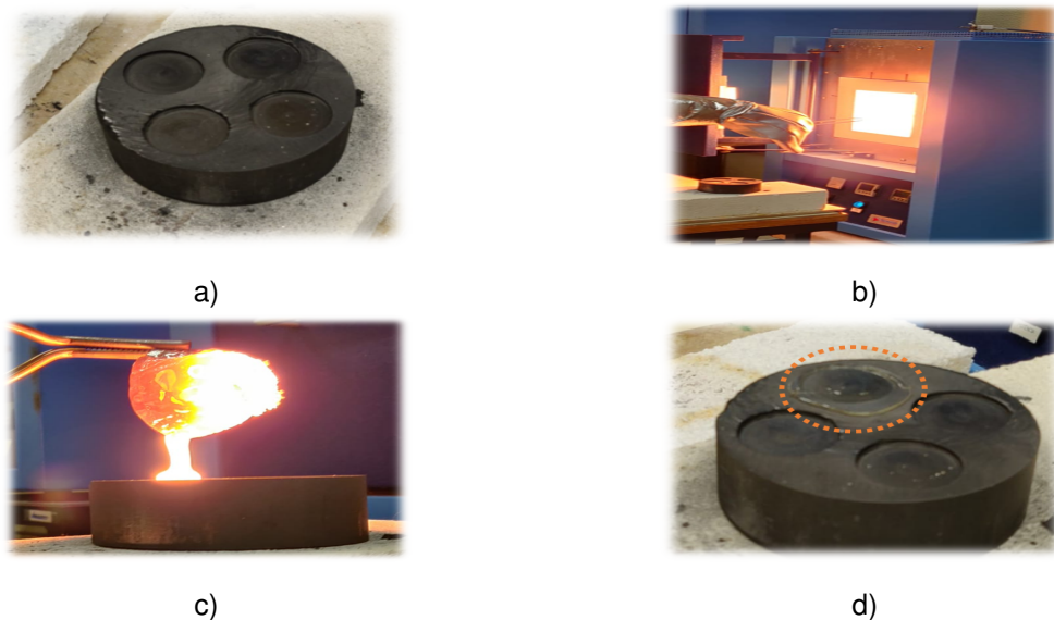
Figura 3.4: Várias fases do vazamento de amostras de vidro GM3: a) Molde de grafite a 300°C, b) Retirada do cadinho do forno para fazer um vazamento, c) Líquido viscoso durante o vazamento, d) Amostra após vazamento
