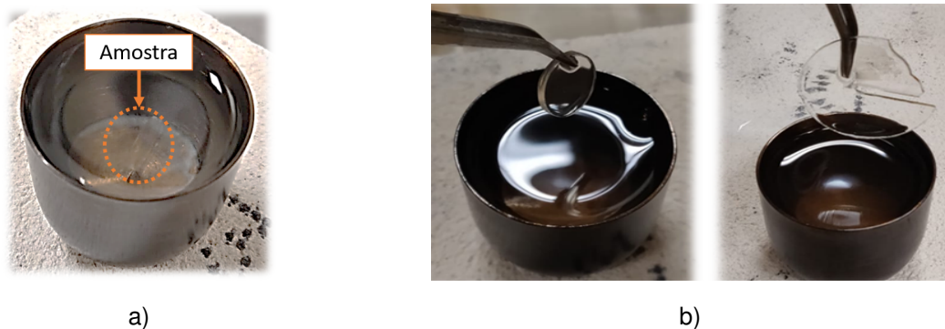
Figura 3.5: Várias fases do processo de permuta iónica: a) Amostra durante o processo de permuta iónica, b) Amostra e suporte da amostra a serem retirados do sal de permuta
