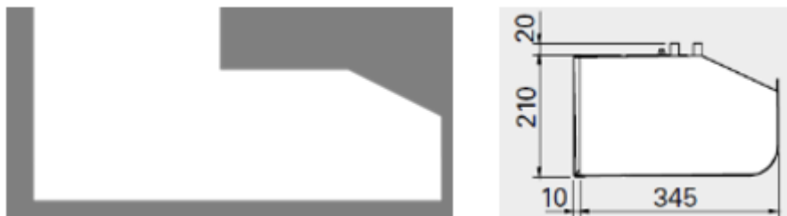
Fig. 38 - Perfis da cortina de ar PA2515A da FRICO, no Star-CCM+ (à esquerda) e na folha de especificações da FRICO (à direita)
