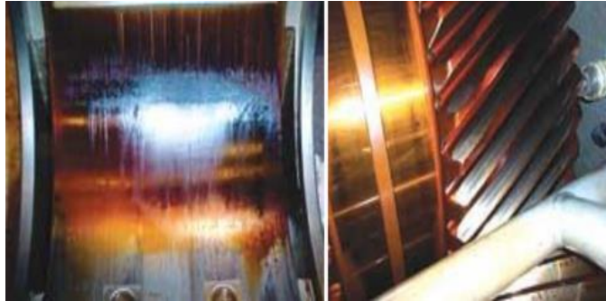
Figura 2.5: Formação de vernizes numa turbina a gás (chumaceiras e engrenagens) [2]
