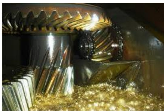
Figura 2.16: Formação de Espuma num óleo lubrificante [35]
