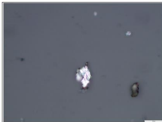
Figura 3.29: Escamas de fadiga (Picagem) detetadas na amostra de 26/07/2017 (25 \mu\text{m} )
