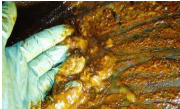
Figura 2.6: Lamas resultantes da oxidação do óleo lubrificante [18]
