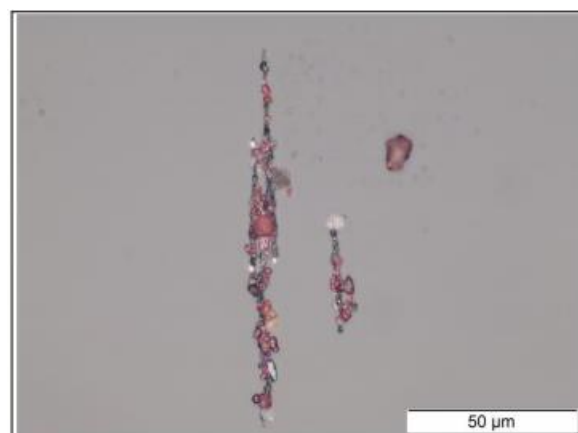
Figura 3.27: Óxidos / Partículas Ferrosas detetadas na amostra de 20/12/2019
