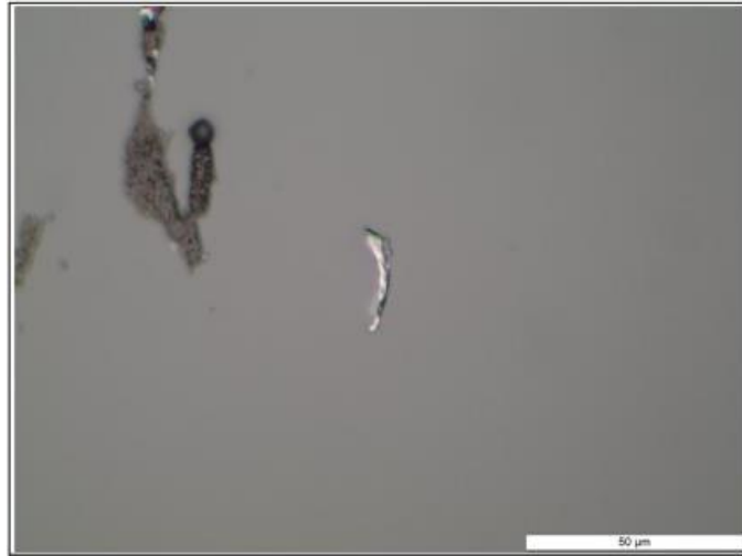
Figura 3.30: Partícula (“limalha”) de desgaste abrasivo detetada na amostra de 29/05/2018
