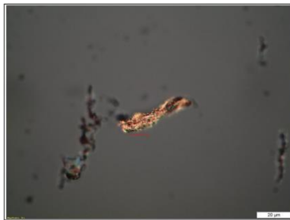
Figura 3.26: Partícula de Cobre detetada na amostra de 28/05/2019
