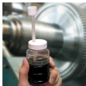
Figura 2.15: Amostra de óleo visivelmente oxidado [33]
