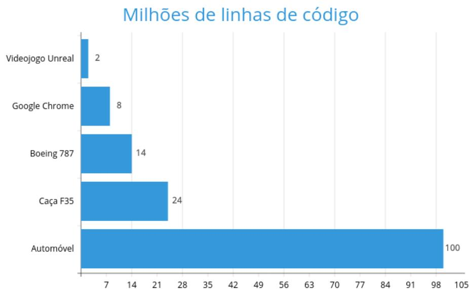
Figura 2.5: Comparação do total de linhas de código entre vários sistemas. Figura adaptada de Lévy-Bencheton [17]
