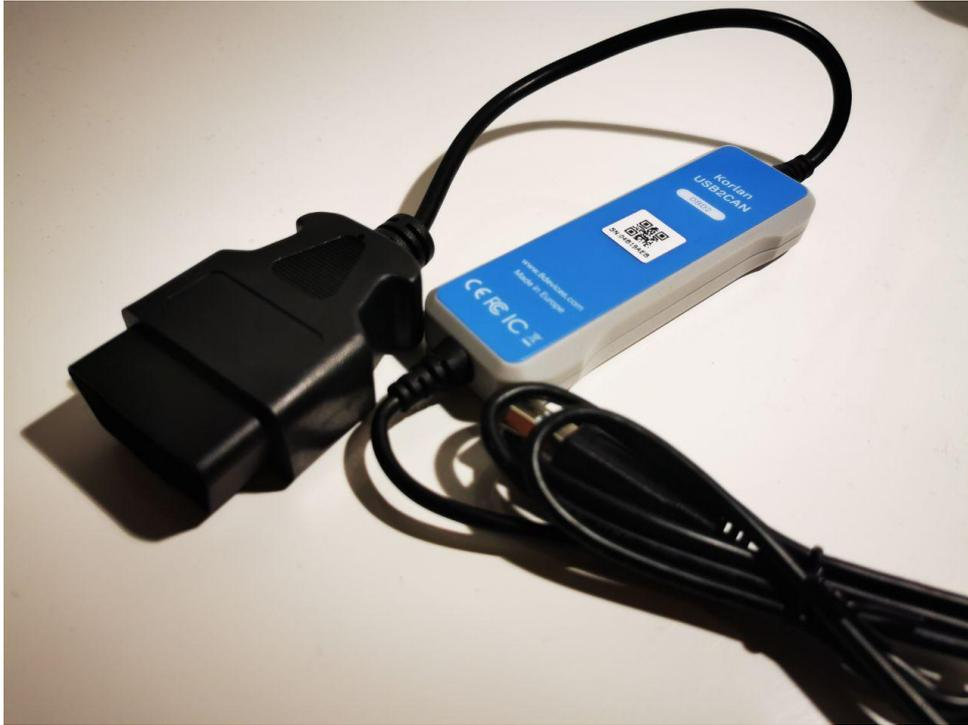
Figura 3.3: Korlan USB2CAN utilizado nos testes
