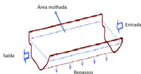
Figura 2.6 – Ilustração do método do balanço hídrico para estimativa de repassos (M 2017)
