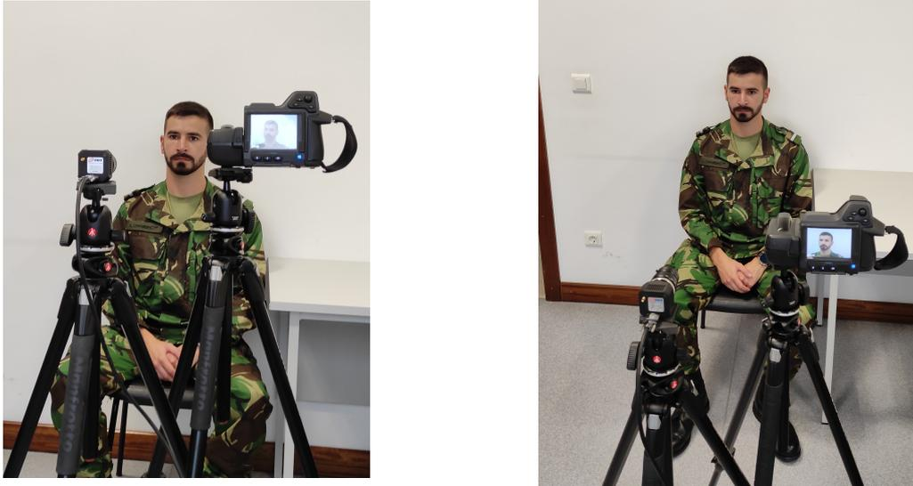
Figura 21: Disposição das câmaras multiespectrais e da pessoa durante a aquisição de imagens.
