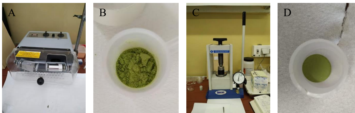
Figura 17 A) moinho RETSCH B) detalhe da moagem C) pastilhador SPECAC e D) pastilha de uma amostra
