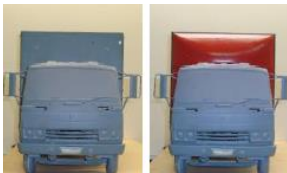
Figura 3 - Comparação de uma viatura sem e com defletor aerodinâmico (Fonte [11]).
