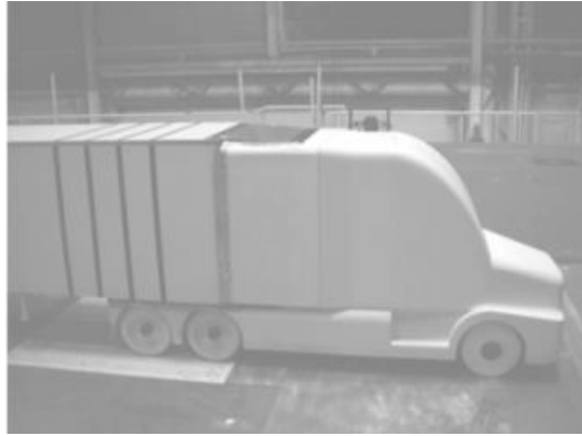
Figura 4 - Espaço entre cabine e semirreboque vedado (Fonte [12]).
