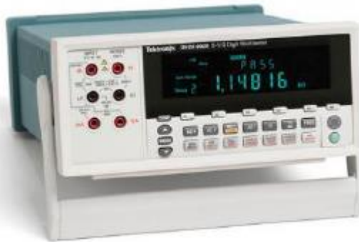
Fig. 3.9 – Multímetro digital utilizado para medir a diferença de potencial na secção de teste. Especificações: https://www.tek.com/linkclickcount?nid=72376&url=http%3A//download.tek.com/datasheet/Tektronix-DMM4020-Digital-Multimeter-Datasheet-6.pdf
