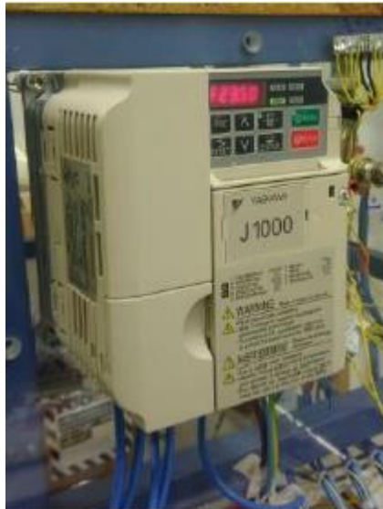
Figura 3.4: Conversor de frequência. Especificações:
