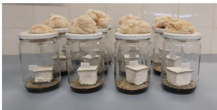
Figura 3.10 - Provetes em frascos com meio de cultura adequado.
