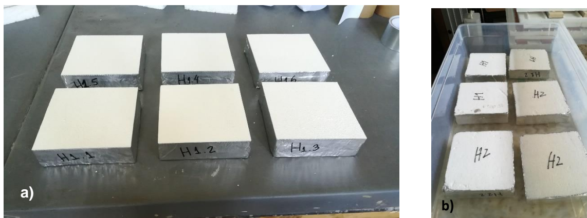
Figura 3.5 - a) Provetes selados com fita cola metálica; b) Provetes de ETICS imersos em água durante o ensaio de absorção de água por capilaridade
