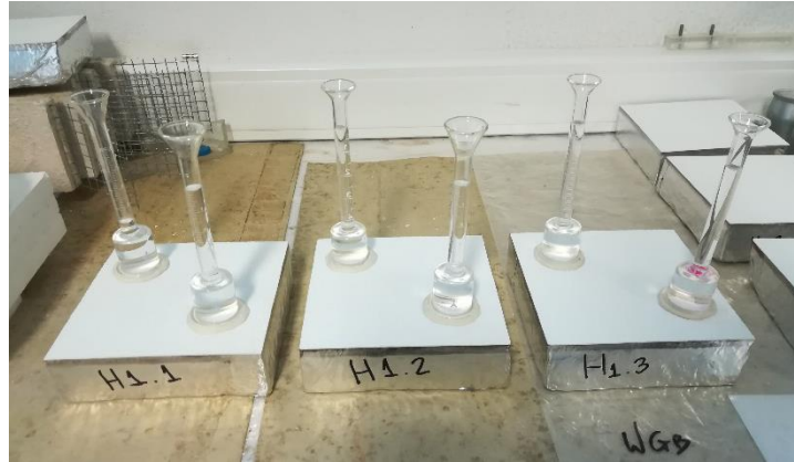
Figura 3.7 - Provetes durante o ensaio de permeabilidade à água sob baixa pressão com tubos de Karsten.
