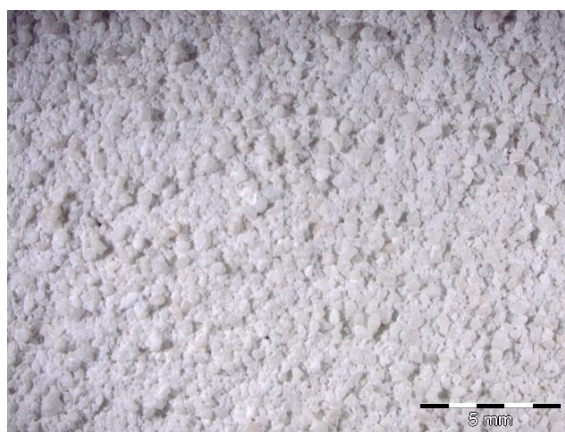
Figura A.4 – Microfotografias do ensaio de suscetibilidade ao desenvolvimento de bolores – Controlo
