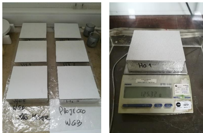
Figura 3.6 - Provetes durante o ensaio de secagem.
