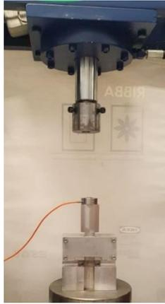
Figura 5.8- Ensaio de arrombamento na prensa hidráulica;
