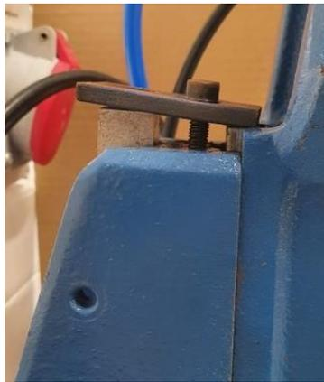
Figura 5.4- Ligação entre corpo da prensa e suporte do carro móvel, com travão para prevenir escorregamento;
