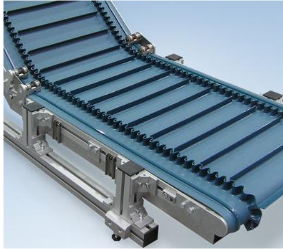
Fig. 14: Pás presentes na superfície do tapete da KFG-P 2000 AS [19]
