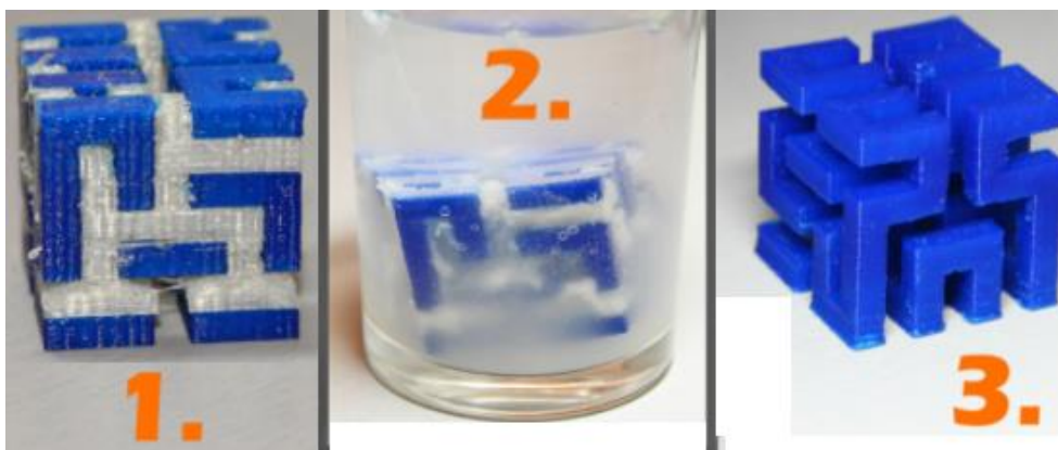
Fig. 45: Remoção do PVA de uma peça através da submersão em água [29]
