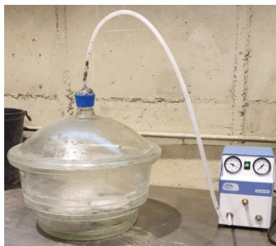
Figura 3.17 – Saturação em vácuo dos provetes
