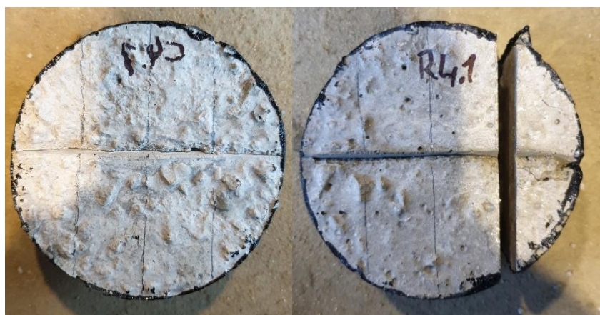
Figura 3.15 - Provetes seccionados durante o ensaio de carbonatação acelerada
