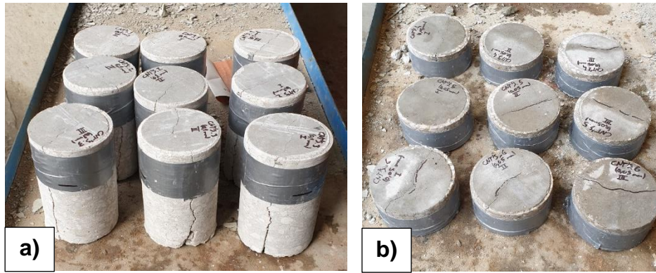
Figura 3.10 – Provetes com fendilhação natural: a) Reforçados com fita; b) Depois do corte
