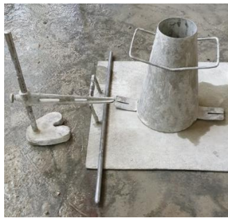
Figura 3.12 – Material para o ensaio de abaixamento
