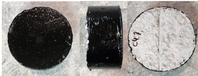
Figura 3.14 - Impermeabilização dos provetes para o ensaio de carbonatação acelerada
