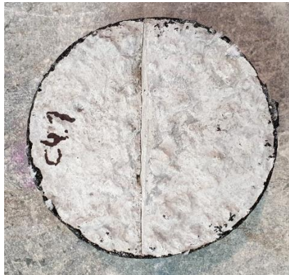
Figura 3.5 - Provete com fendilhação artificial
