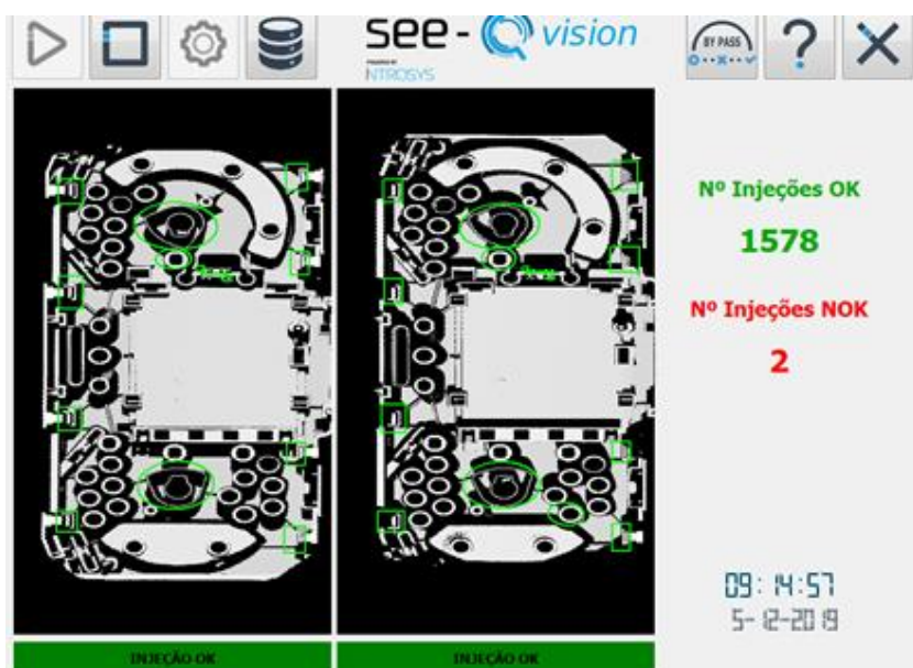
Figura 7: Sistema de Visão para controlo de qualidade automático
