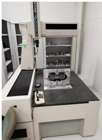
Figura 12: Máquina CMM com peça colocada no fixture e armário de fixtures
