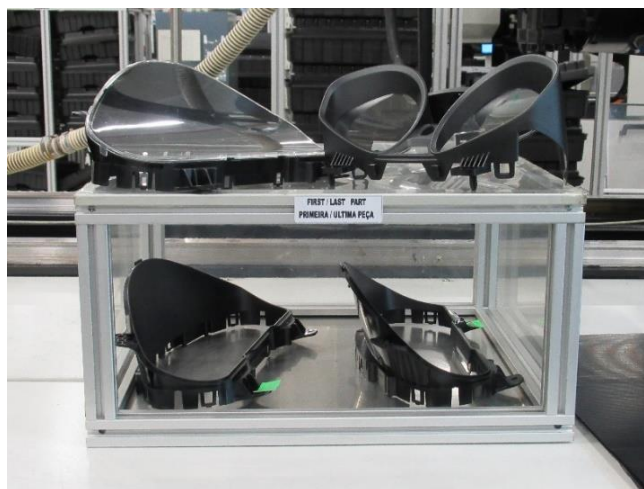
Figura 9: Caixa para primeiras/últimas peças de produção e exemplos de modelos pós-montagem
