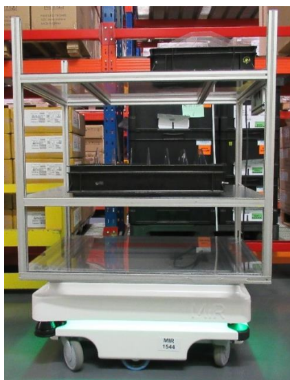
Figura 10: MIR em posição de abastecimento na doca
