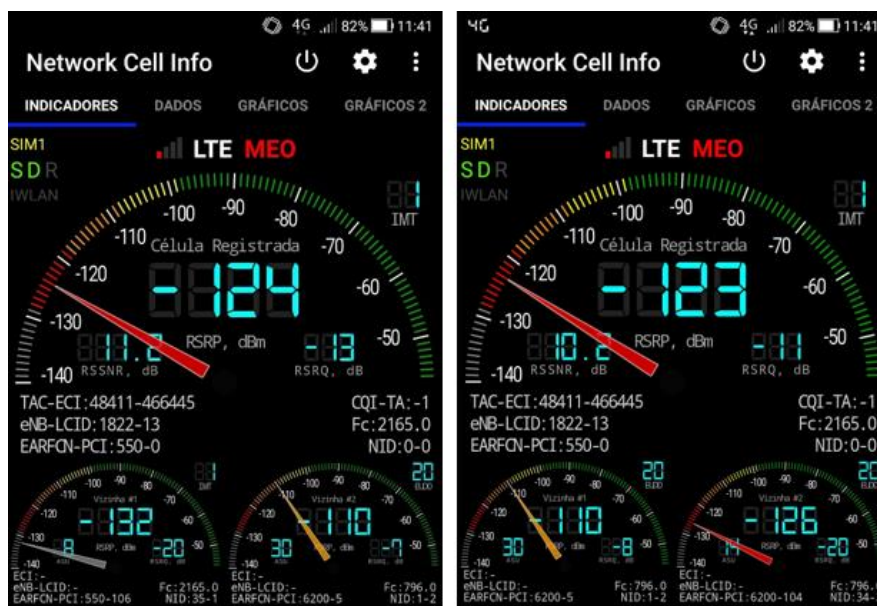
Figura 5.30 - Medições realizadas em ambiente indoor com o terminal móvel conectado ao eNB 1822.
