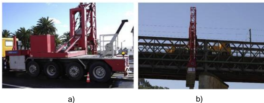
Figura 1 - Exemplo de meio de acesso que auxilia a atividade de inspeção do tabuleiro de uma ponte, local de difícil de acesso. A) equipamento utilizado; B) plataforma de acesso à zona inferior da ponte. (Valença et al, 2017);
