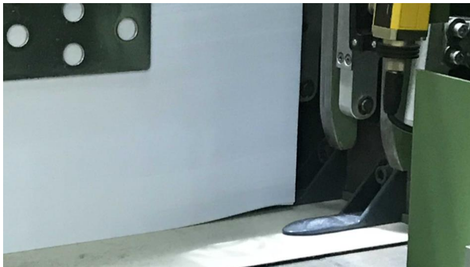
Figura 3.9 - Componente em condições de serviço a suportar pilha de papel.
