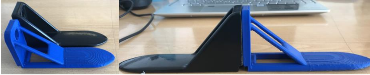
Figura 4.22 – Primeira proposta (azul) em comparação com a peça original (preto).
