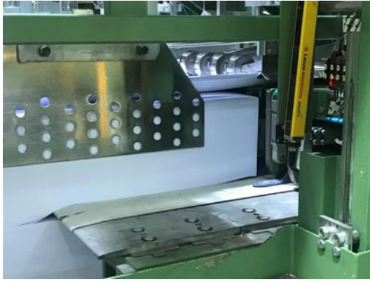
Figura 3.7 - Separação das paletes (lado esquerdo) e papel empilhado (lado direito).
