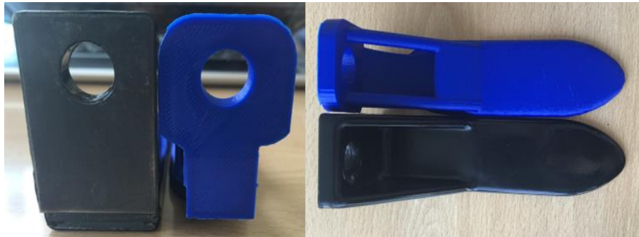
Figura 4.23 - Segunda proposta (azul) em comparação com a peça original (preto).
