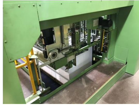
Figura 3.7 - Separação das paletes (lado esquerdo) e papel empilhado (lado direito).
