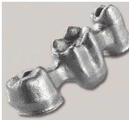
Figura 2.12 - Prótese dentária de titânio produzida por SLM. [10]
