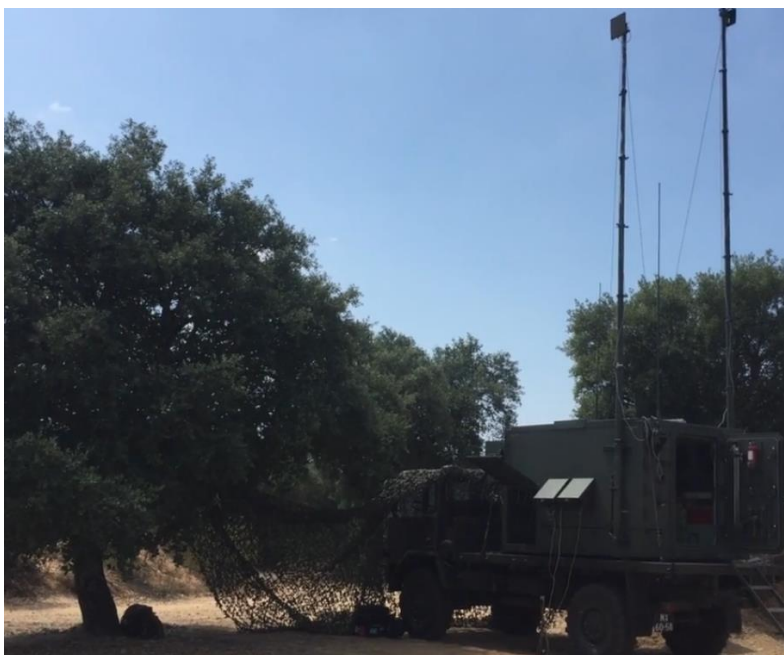
Figura 4.7 - Ponto de Acesso Rádio (PAR) presente no BFM3
