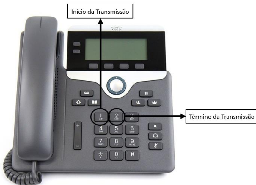
Figura 2.12 - Implementação do protocolo de PTT nos telefones fixos [21]
