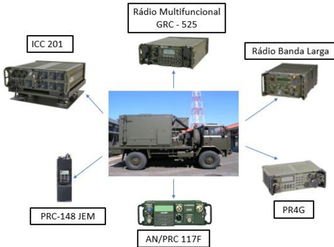
Figura 2.3 - Exemplo de possíveis equipamentos instalados no PAR
