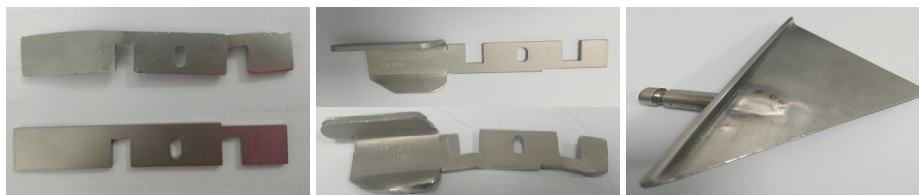
Figura 4.2: Peças de desgaste rápido - CdT de Compressão Killian D e Killian BB
