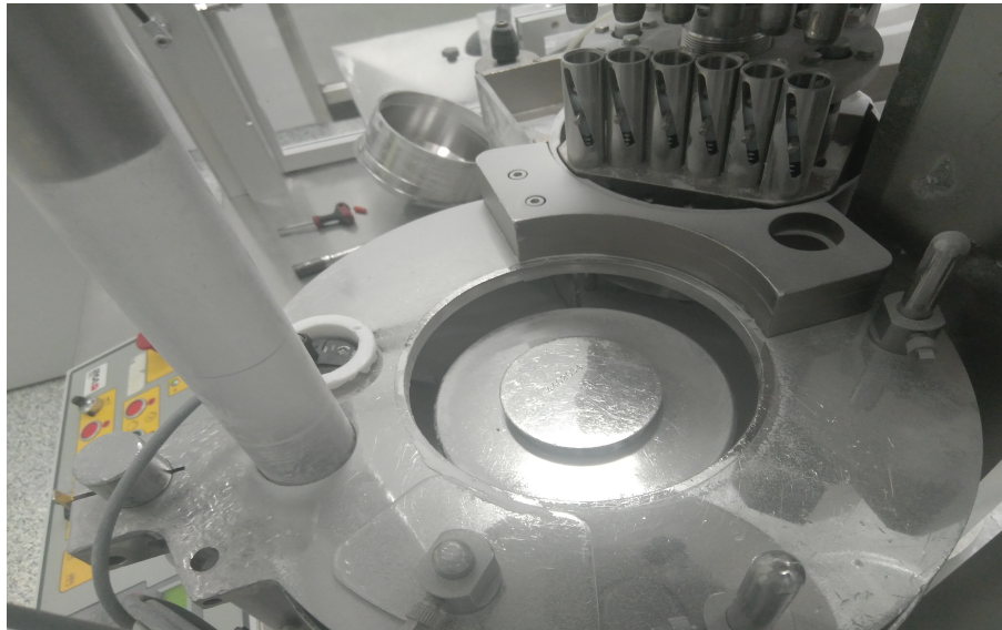
Figura 4.4: Depósito do doseador - CdT Enchimento de cápsulas
