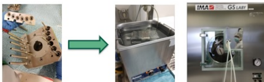
Figura 4.7: Novo método de lavagem do grupo doseador CdT enchimento de cápsulas
