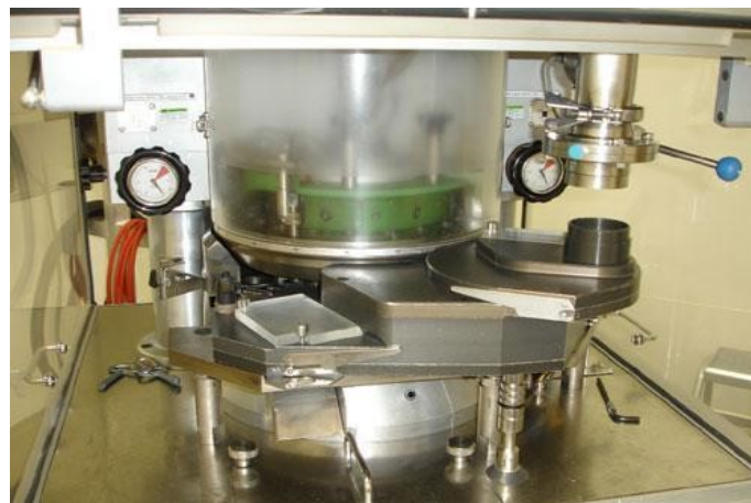
Figura 2.4: Máquina de comprimir Manesty Unipress Diamond - torreta e alimentador
