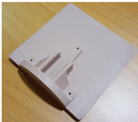
Figura 4.18: Molde final do suporte do porta cubos
