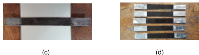
Figura 3.19: Preparação dos provetes: (a) Marcação dos provetes segundo a norma ASTM D 3518 (b) Exemplo de um provete cortado para as dimensões necessárias (c) Preparação das extremidades do provete (d) Provetes após colagem dos reforços
