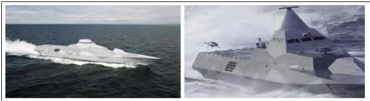
Figura 1.2 – Laminados compósitos híbridos CFRP/GFRP numa corveta de classe Visby [8].
