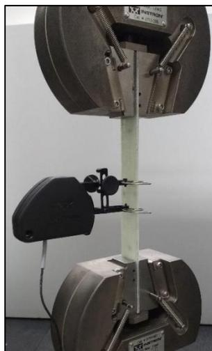
Figura 3.4 – Provete amarrado, com extensómetro.
