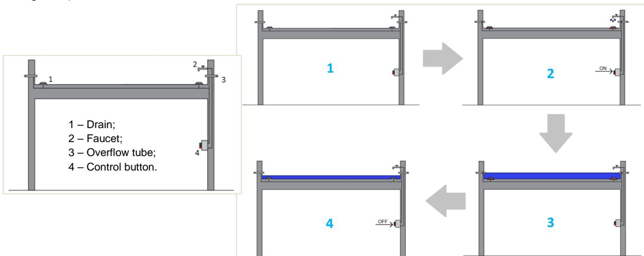
FIGURE 8 – LEGEND OF THE COMPONENTS (ON THE LEFT) AND PROCEDURE SEQUENCE OF THE PROPOSED CONTROL SYSTEM (ON THE RIGHT).
