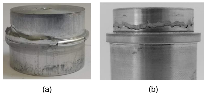
Figura 20 – Resultados dos primeiros ensaios experimentais (a) Varão deformado em condições do Caso A com a=6\text{mm} b) Varão deformado em condições dos Caso B e C.
