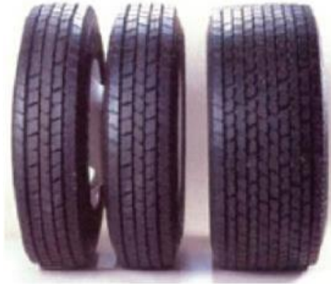
Figura 2 - Exemplo da configuração de duplo pneu (esquerda) com os pneus individuais (direita) [6]
