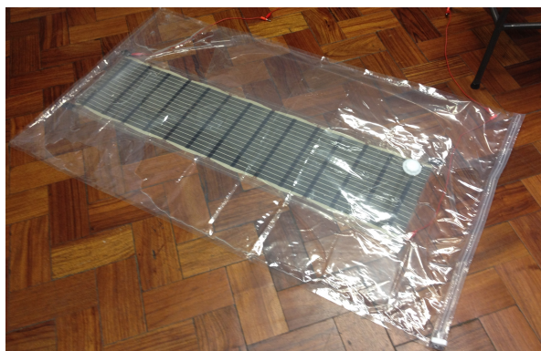
Figura 3.14: Painel orgânico sob um saco plástico transparente, para realizar a experiência.
