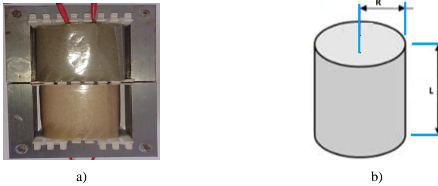
Fig.3. 21: a) - Circuito magnético; b) - Aproximação do circuito magnético a um cilindro.
