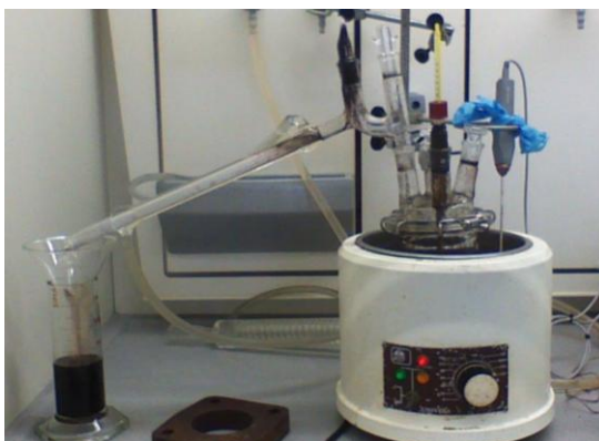
Figura 4- Montagem utilizada no procedimento experimental de produção de furfural.
