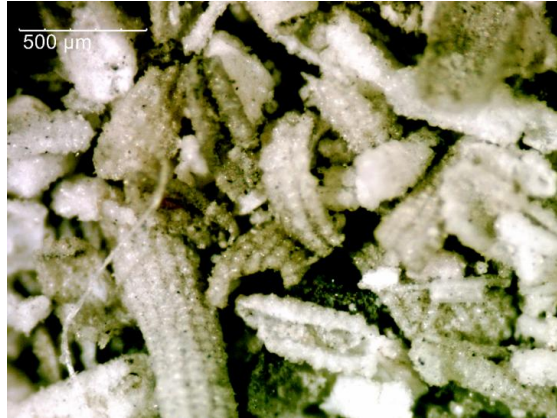
Figura 46- Ampliação do sólido obtido após tratamento na mufla partindo da casca de arroz como substrato.
